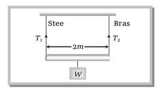
Solution: (d) Stress =  $\frac{\text{Tension}}{\text{Area of cross-section}} = \text{constant}$
