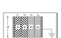
$$C = \frac{\varepsilon_0 A}{\left(\frac{t_1}{K_1} + \frac{t_2}{K_2} + \frac{t_3}{K_3} + \frac{t_4}{K_4}\right)}$$
